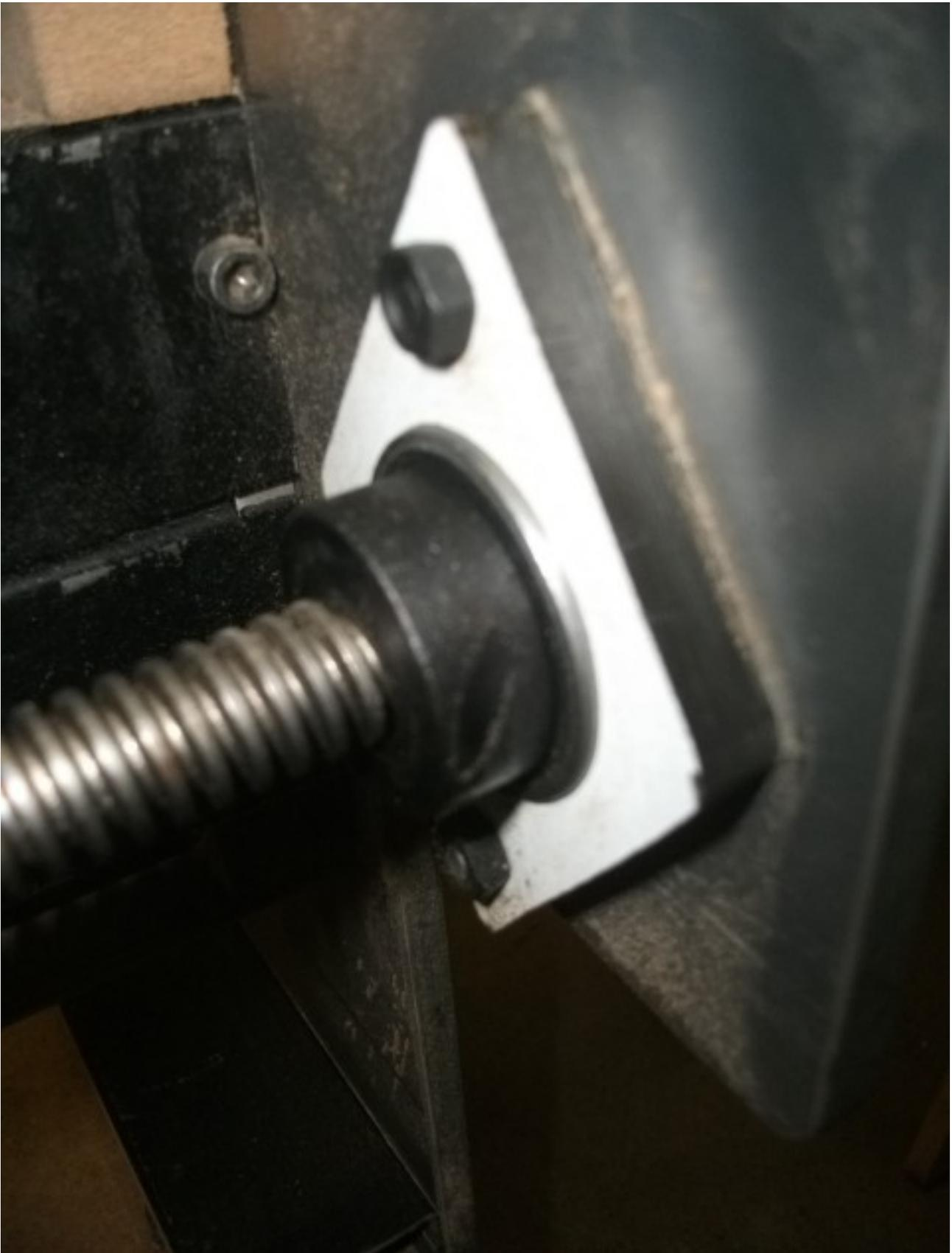
Pour ce qui est de l'entrainement des chariots, j'ai simplement percé et taraudé des écrous carré trapézoïdal et je les ai fixé sur mon bâti :
