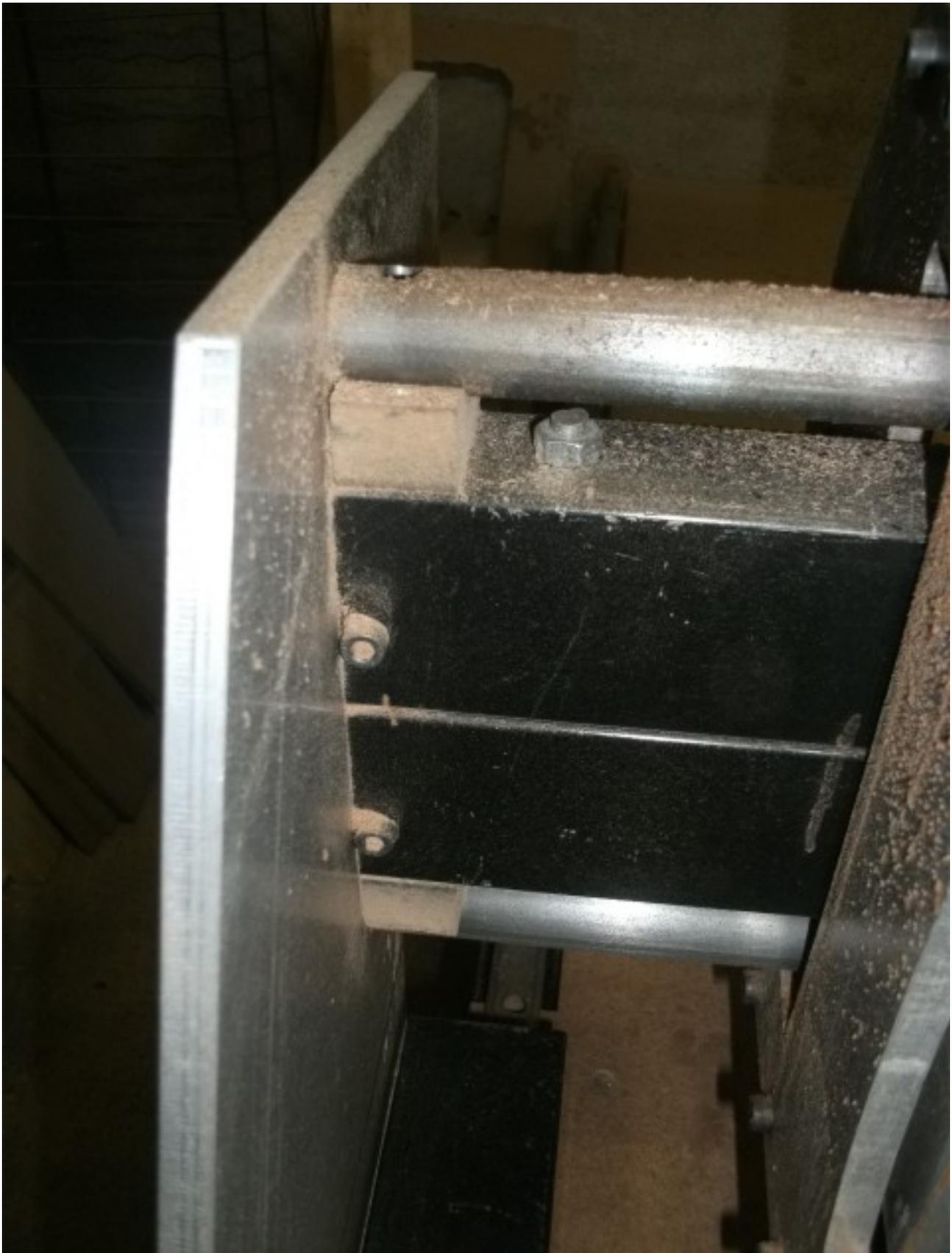
Regardez également les supports de tube en MDF de 19mm....Chaque supports à été retravaillés à la main pour rattraper les déformations liées aux soudures sur les tubes rectangulaire d'acier, et ainsi afin d'aligner parfaitement les tubes cylindrique.
