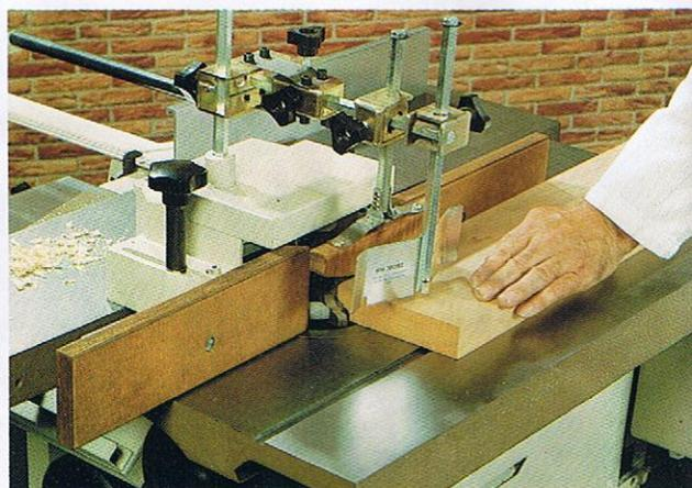
**TOUPILLER** : Plan de travail en fonte. Arbre escamotable. Montée-descente par volant avec blocage de hauteur d'arbre. Guide de toupie fermé à réglage micrométrique.
