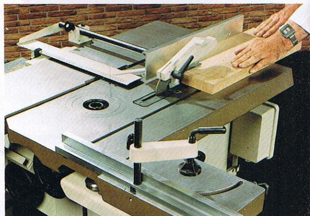
**SCIER** : Lame carbure escamotable. Guide de sciage inclinable à 45°, réglable longitudinalement et, qui démonté, permet la coupe de grands panneaux. Guide additionnel pour le sciage des petits bois. Réglet indiquant la largeur de coupe entre lame et guide. Evacuation latérale des sciures par carter de protection.
