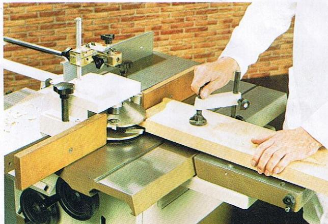
**TENONNER** : Chariot de sciage et tenonnage rigide, précis et escamotable. Déplacement sur roulements. Guidage par vés en fonte usinée. Tablette de tenonnage indépendante. Guide profilé orientable. Butées de guide à 90° avant et arrière. Serre bois à vis.
