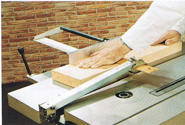
**DEGAUCHIR** : Plan de travail en fonte nervurée. Arbre à 2 fers. Longues tables pour faciliter le dressage des bois. Verrouillage des tables évitant tout dérèglement. Guide de dégauchissement en profilé rigide, inclinable à 45°.
