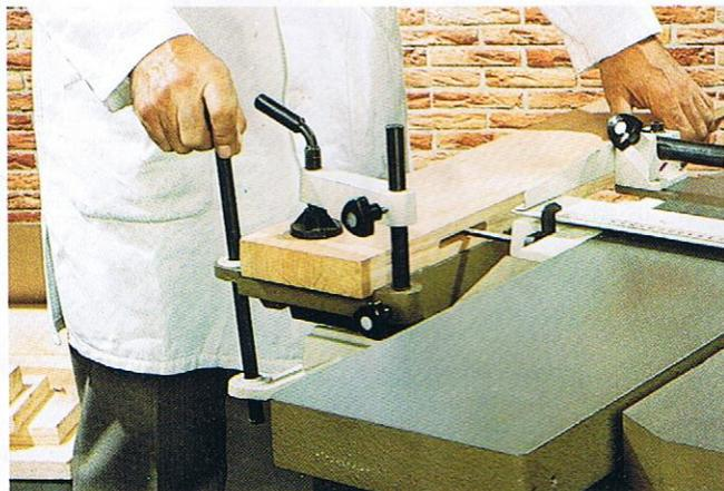
**MORTAISER** : Table à double déplacement montée sur vés usinés et roulements. Levier unique à rotule assurant une opération souple et précise. Montée-descente commandée par le volant de la raboteuse. Mandrin 3 mors. Butées de longueur et profondeur de mortaise, avec réglage gradué. Serre bois à vis.
