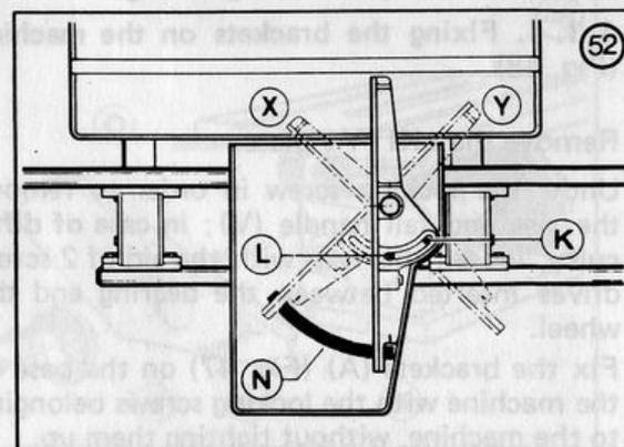
Choisir le logement du boulon en fonction de l'orientation du guide (Fig. 52).
