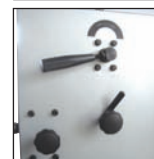
Poignée de serrage rapide de la lame.
